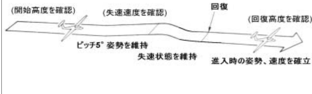
通常の水平飛行から、高度を維持しながら約5°ピッチアップの姿勢を確立しその姿勢を維持する。ピッチ確立後は高度は維持しなくてよい。トータルエナジータイプの昇降計は参考にならない。低速になるに従い、所望のピッチ姿勢を維持するための操舵量、感覚を体感する。失速に近づくとつれエルロンの効きも鈍くなる。ラダーでのバンク修正は、グライダーの場合応答が鈍く、失速速度近傍ではラダーの過大な操作によりスピンに陥る可能性がある。
